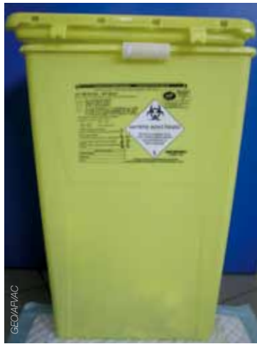
Container d'élimination des déchets contaminés. Étiqueter : "déchets chimiques à risque toxique - à incinérer".
